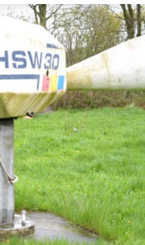
Zum Inventar des Erlebnisparks gehört auch dieser aus-rangierte Rotor einer Windenergieanlage aus den 1980er-Jahren. Er leistete seinerzeit magere 30 kW.
